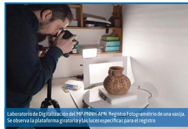
Laboratorio de Digitalización del MP-PNNH-APN. Registro Fotogramétrico de una vasija. Se observa la plataforma giratoria y las luces específicas para el registro
